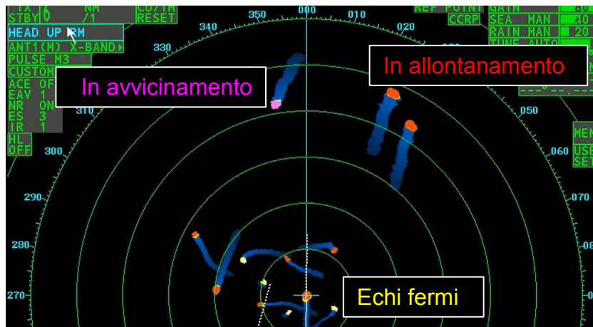
Echi sono visualizzati a tre colori nella modalità Target Analyzer
